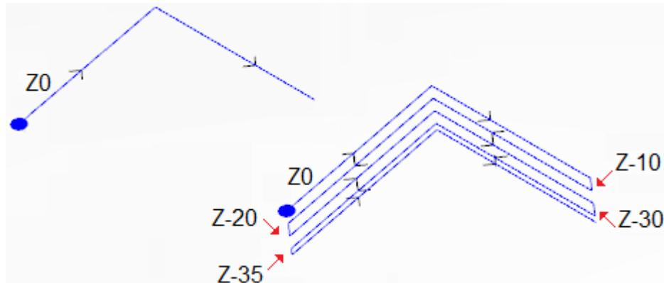
Links sind die Original-Profile zu sehen, denen zwei lineare Segmenten zugewiesen wurden, die mit einer Tiefe  $Z = 0.0$  ausgeführt werden.
