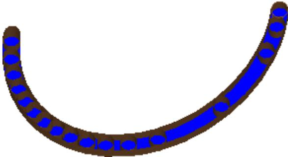
**Gesamtabmessungen des Profils mit Aussenkonturen:** Die Profile werden mit einer Dicke dargestellt, die der Werkzeugausdehnung entspricht, aber mit einem nicht vollständigen Profil. In der Darstellung werden die externen Konturlinien für das Profil angezeigt. Diese Auswahl schließt die Darstellung von Kantenpunkten und Richtungspfeilen aus.
