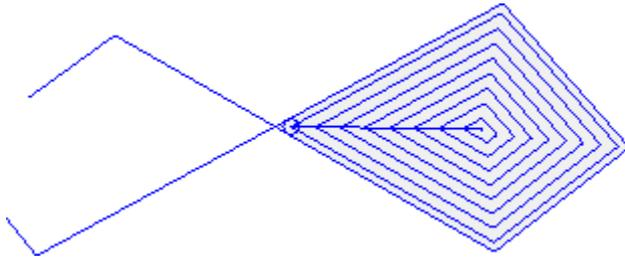
In dieser Abbildung wird die Entleerung eines Profils, welches nicht geschlossen ist, gezeigt: Die Überprüfung des Entleerungsvorgangs wird in den bestehenden geschlossenen Bereichen durchgeführt.
