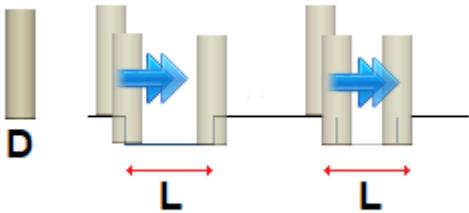
Auf der linken Seite ist eine Brücke ohne Werkzeugkompensation ausgeführt und rechts ist dieselbe Brücke mit interner Kompensation:
