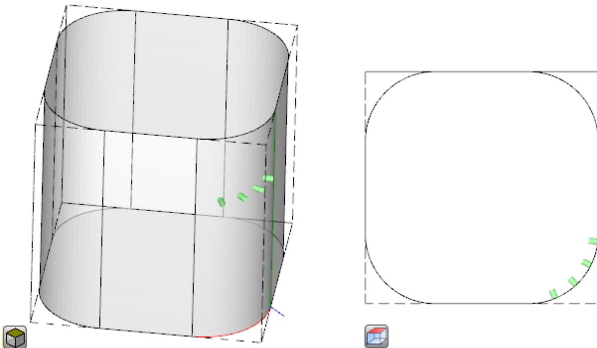
Das Programmieren eines orientierten Setups kann den Modus von **Tangententracking** aktivieren, das entspricht der Aufforderung, die Achse bei der Ausführung des Profils senkrecht zu halten. In diesem Modus wird ein nicht vertikales Fräsen durchgeführt (die Achse des Werkzeugs verläuft parallel zur XY-Fläche-Ebene oder zur schiefen Ebene, jedoch nicht senkrecht zur XY-Ebene), wobei die Drehachse des Werkzeugs beibehalten werden muss senkrecht zum auszuführenden Profil.
