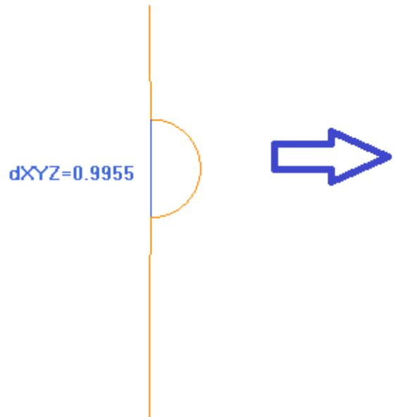
Links ist der ursprüngliche Pfad hell dargestellt; es ist klar, dass der eingerückte Bereich und das blaue Segment eine Skala markieren, die weniger als 1 mm beträgt;
