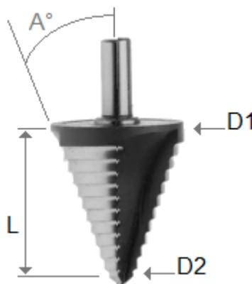
dargestellt durch zwei extrem-Durchmesser und den Winkel des Konus. Dieses Werkzeug höhlt das Material eindeutig entsprechend dem verwendeten Teils aus: Umso höher die programmierte Tiefe, desto größer der Werkzeugdurchmesser, welcher auf die Oberfläche des Werkstücks trifft.
