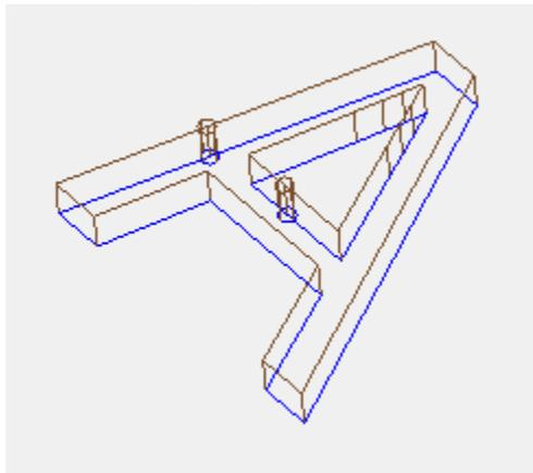
Die Zeichnung zeigt eine 3D-Darstellung der Profile, mit der Ansicht Gesamtabmessungen aktiviert: Jedes Profilsegment unterstreicht die Werkzeuggesamtabmessungen auf dem Werkstück. Die Standardeinstellung: gesperrt.
