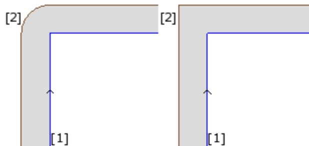
In der linken Abbildung bewegt sich das kompensierte Profil mit einem Radiusbogen, der dem Werkzeugradius entspricht, um die ursprüngliche Ecke. In der Abbildung rechts setzt sich das kompensierte Profil bis zum äußeren Schnittpunkt der kompensierten linearen Segmente fort.
