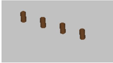
Die Darstellung zeigt die 3D-Darstellung für eine Punktbearbeitung (oder einzelnes Setup), die eine Gesamtansicht hat: Für jede Bearbeitung wird ein kleiner Zylinder angezeigt, dessen Höhe der programmierten Tiefe entspricht. Die kleine Zylinderfüllung wird durch die Auswahl **Aussehen von Punkten und Setups mit gefülltem Bereich anzeigen** bestimmt. Standardeinstellung ist nicht aktiv.
