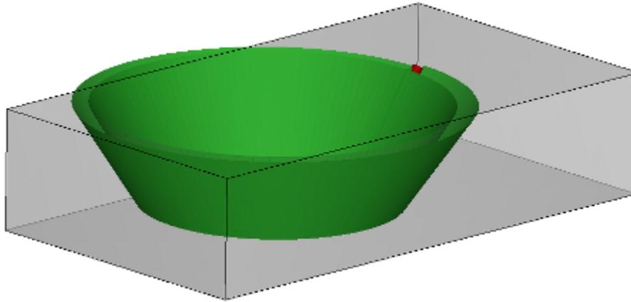
Wenn das **Tangententracking** überprüft eine Ausrichtung des Werkzeugs senkrecht zur Fläche, entspricht dies der Aufforderung, die Achse des Werkzeugs bei der Ausführung eines Profils senkrecht zu halten, auch wenn sich die Stelle der Fläche ändert, und dies gemäß der folgenden Anweisung des Falls eines vertikalen Setups.
