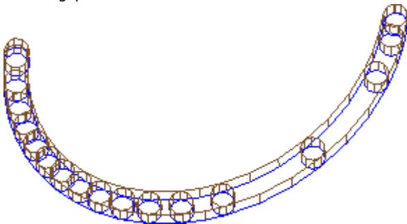
Die vollständige Segmentansicht kann im Falle von Entleerungsprofilen besonders nützlich sein, um die tatsächliche Materialentnahme zu schätzen. Die Abbildung verdeutlicht den Unterschied zwischen den beiden Darstellungen.
