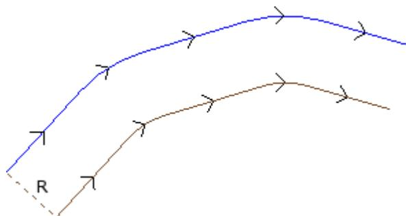
Das ursprüngliche Profil ist außen. Das korrigierte Profil ist innen, so ist es nötig, dass die **Korrekturseite Rechts** ist.
