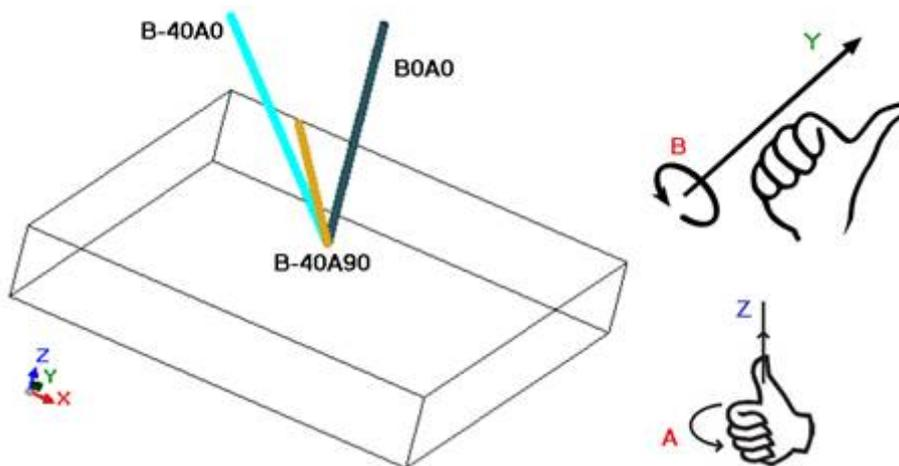
In einer Setup-Bearbeitung, die die Werkzeugausrichtung zuweist, sind die XYZ-Koordinaten in Bezug auf den nicht orientierten Setup-Fall von Bedeutung.
