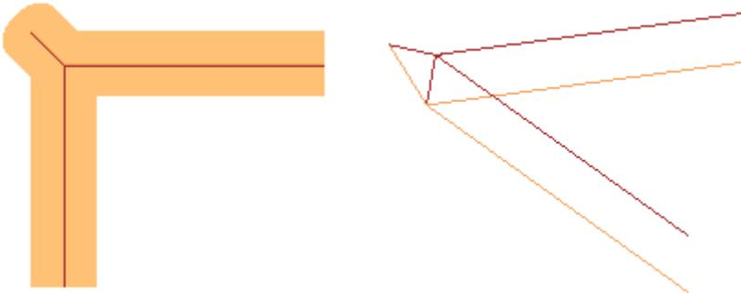
Wie in der Abbildung deutlich zu sehen ist, wird die Erhöhung an der Ecke zum „äußeren Teil“ des Profils hinzugefügt. In einem rechteckigen Profil könnte das Finden eines externen Teils nicht klarer sein, manchmal ist dies jedoch nicht der Fall. Ein Profil kann konkave und konvexe Teile zeigen und kann geschlossen oder offen sein. Aus allen diesen Gründen sind mit dem Feld **Scharfkantiger Schnitt** vier mögliche Optionen verbunden:
